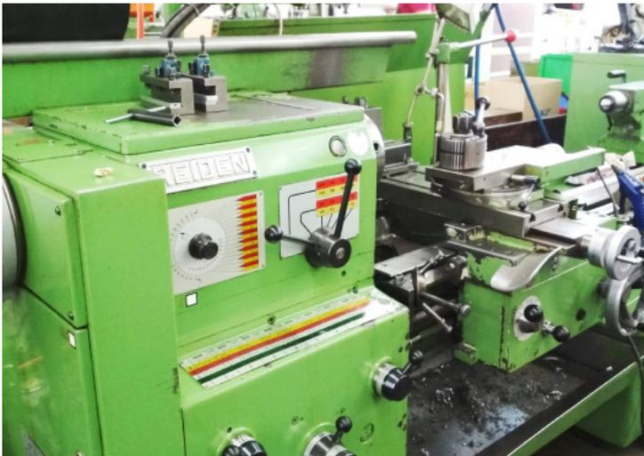
Leitspindel Drehbank REIDEN
